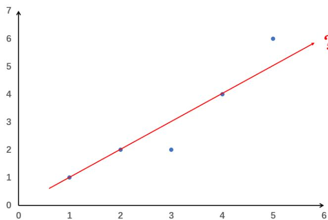
这时候，数据并不是严格落在一条直线上，换句话讲，我们不能像理想数据集那样，快速地找到一条穿过数据重心的线，直接形成新的坐标系。该如何寻找新坐标系的原点和数据分布方向呢？
